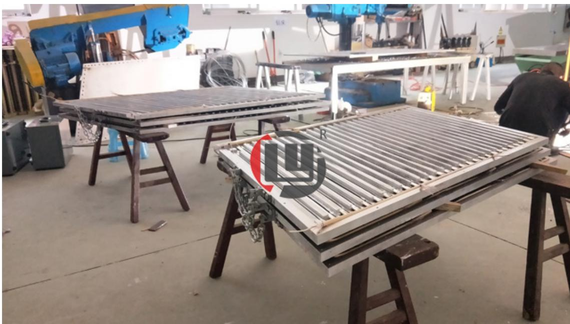
龙宇LYLHJ型水冷却硫化机，该设备只要使用现场有普通自来水源，即可在硫化完成后，对加热板通水快速冷却。既可大幅度提高效率又可提高胶带接头质量，一般从硫化温度冷却到60℃、10分钟即可，冷却水源压力 $\geq 0.2\text{mpa}$ 。水冷却硫化机构件轻巧，一般人工均能搬动，安装前要考虑到电源及水源的方便。用专门水管将自来水与硫化机上下加热板冷却水管接通，但暂时不要放水，此时开始恒温到硫化恒温时间结束，此时打开自来水，向热板通水，当温度下降到工艺规定值时，即可放水拆卸设备，硫化作业完成。南京小型硫化机为什么不要在雨天在室外使用硫化机？
