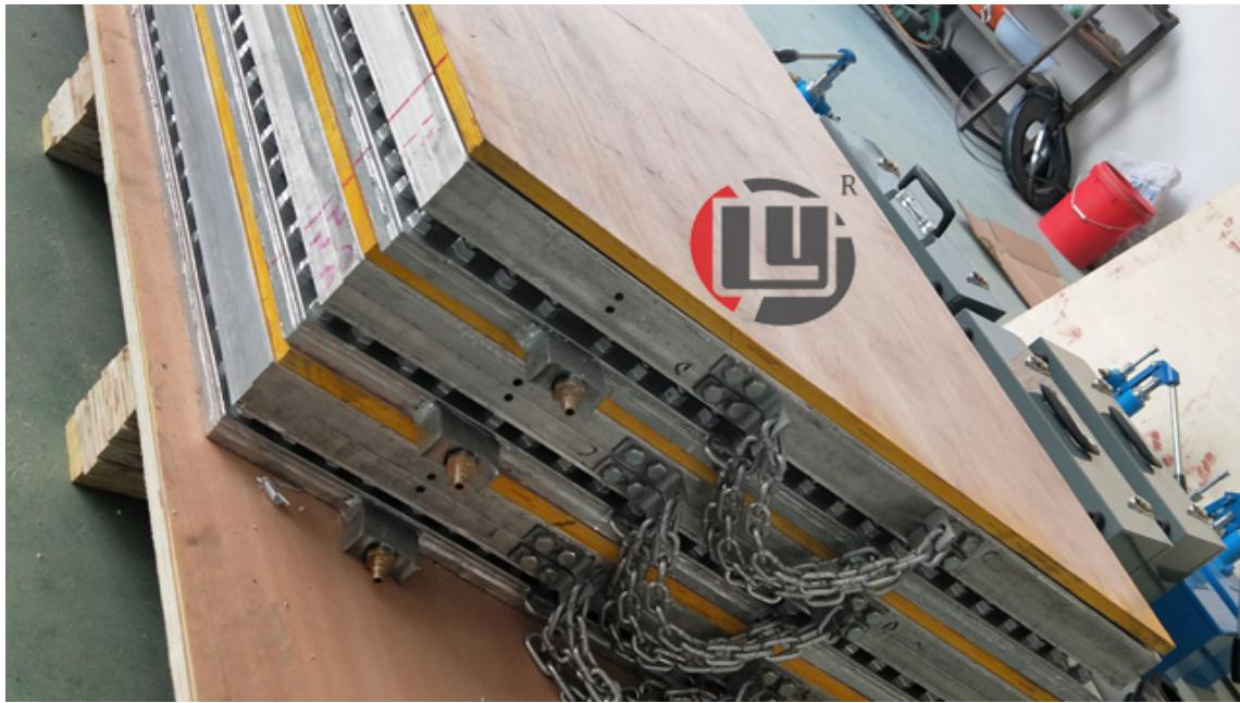
硫化机的性能及温度控制：自动控制可实现合模、排气、控温、硫化计时、报警、开模卸荷等功能；触摸屏适时显示热板各加热区的温度。液压缸采用ZG270-500材料，柱塞采用质地密实的冷硬合金铸铁，铸后精磨而成；液压缸的密封形式为YX型密封圈。热板锅边采用液压自动顶铁，在四个油缸的作用下热板两侧的垫铁同时进退；热板两端设有防垫铁重叠装置。热板的每个加热区都设有一组调节温度的阀组，在PLC的控制下，保证热板的各个加热区温度均匀一致。
